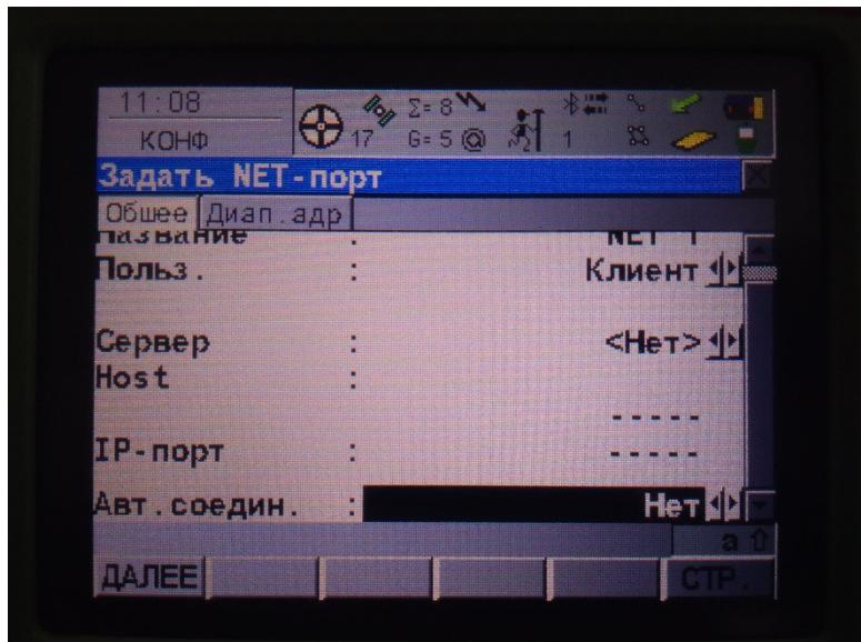
Клацнувши на рядок «Сервер» нам відкриється вкладка «Сервер для подключення» в якому будуть перечислюватися усі створені сервери на даному пристрой.
