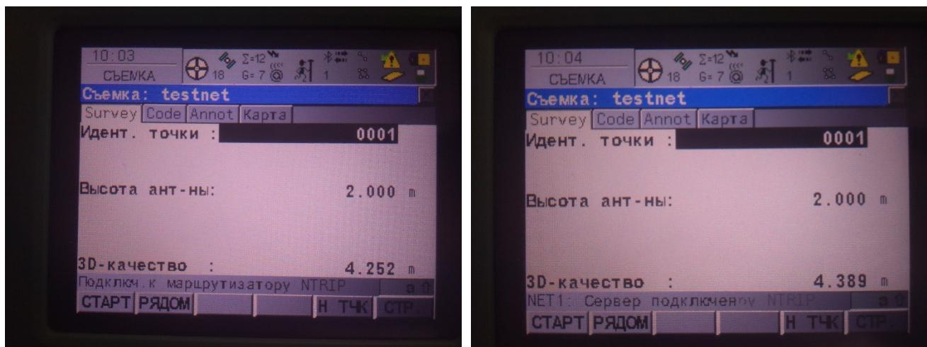
Тепер прилад отримує поправки від базових станцій, звертати увагу треба на пункт «3D-качество» та на значок у верхній частині екрану.
