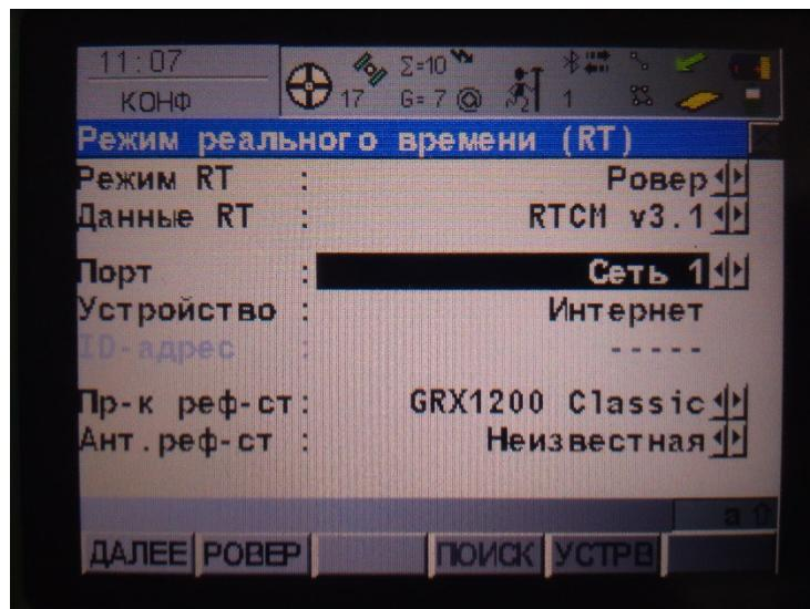
Після збереження налаштувань зберігаємо внесені зміни. Нас повертає до вікна «**Interfaces**» («**Интерфейсы**») де видно що в пункті «**Real-Time**» («**Режим РВ**») з'явилася кнопка «**CTRL**».
