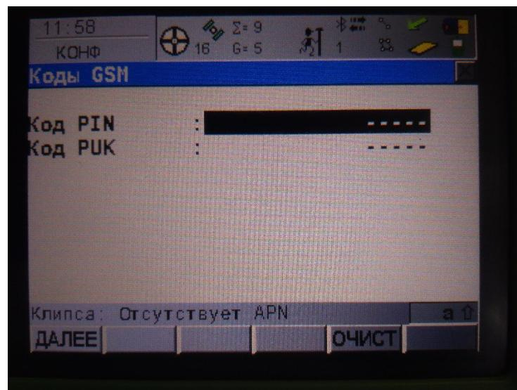
6. Після збереження усіх налаштувань в нижній частині екрану з'явиться повідомлення що «Клипса: GSM Инициализировано», після даного повідомлення з'явиться ще одне яке повідомляє нам по
