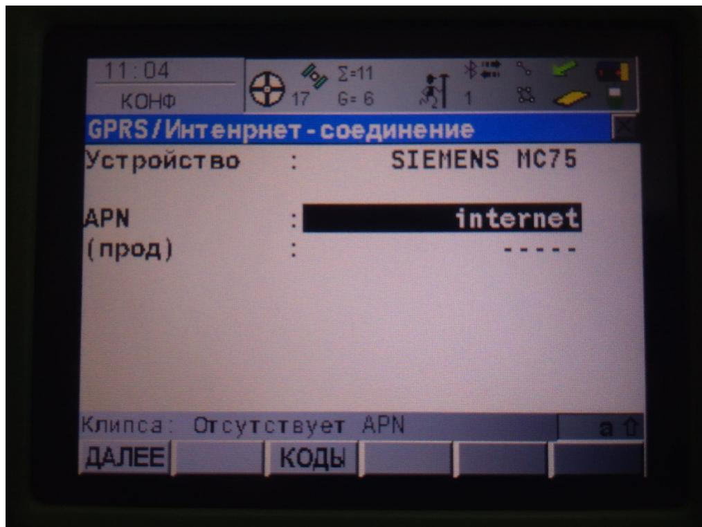
5. Натиснувши на кнопку «CODES» («Коды») в нижній частині екрану, відкриється вікно «GSM Codes» («Коди GSM»). Якщо на карточці стоять PIN та PUK код, то їх треба вести. Якщо на карточці їх нема то просто залишайте рядки порожніми. Натискаємо на клавішу «CONT» («Далее») в даному вікні, та у вікні «GPRS/Internet Connection» («GPRS/Интернет-соединение») для збереження внесених змін і повертаємся до вікна «Interfaces» («Интерфейсы»).
